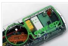
DWUBIEGUNOWY WYŁĄCZNIK SIECIOWY SYGNALIZACJA OCHRONY PRZECIWPRAZIEBIOWEJ
